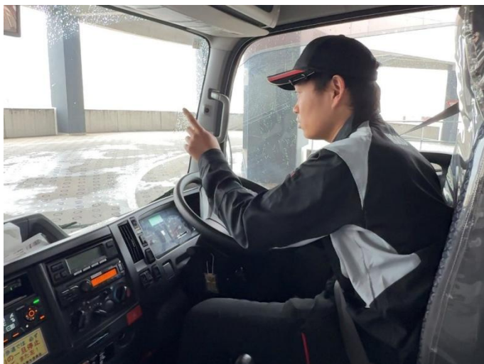
合流地点で指差し呼称による安全確認
